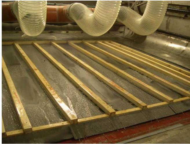
Fase 2 - Prøving av undertaksfelt i RAWI boks
