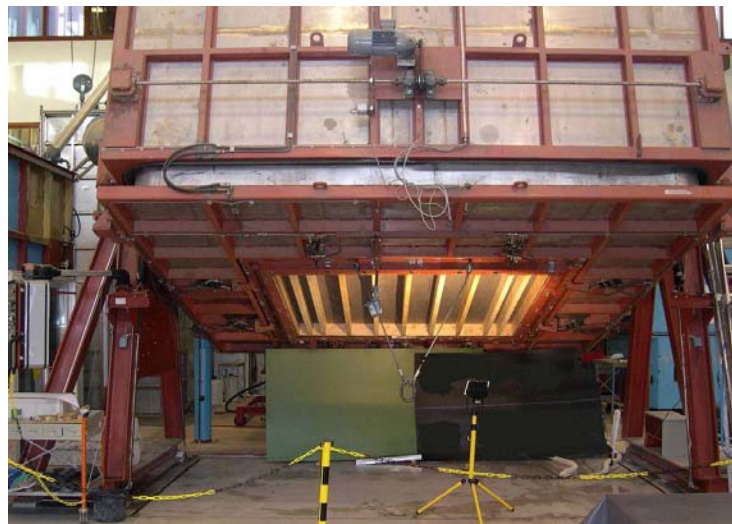
Fase 2 -Prøving av undertaksfelt i RAWI boks
